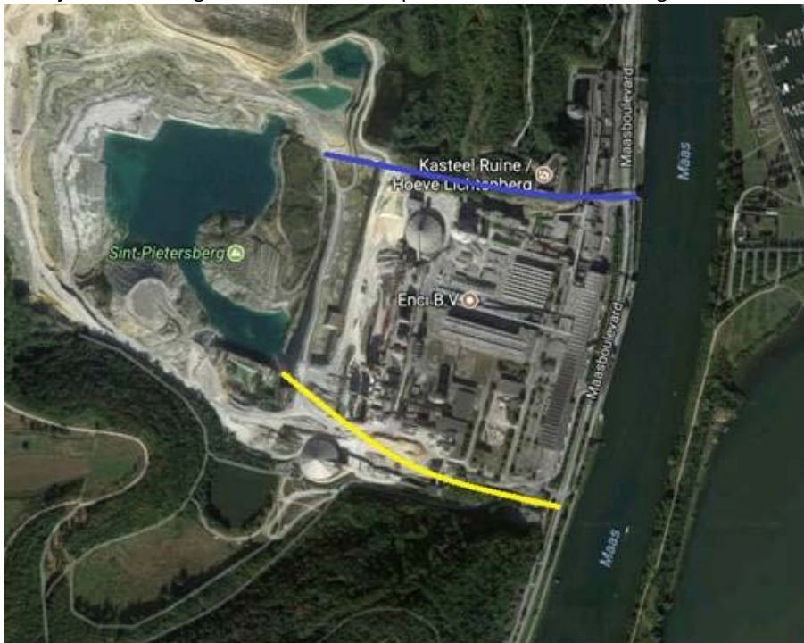
Figuur 1. De groeve met ca. 7,5 mln. m 3 retentiecapaciteit kan via een kanaal vanuit de Maas gevuld worden door een inlaatwerk te openen (of een wand te laten kantelen). Indien het vullen van de groeve symmetrisch rondom de piek van het hoogwater plaatsvindt kan een piekvervlakking van ca. 100 m 3 /s gerealiseerd worden, die ver in benedenstroomse richting doorwerkt.
