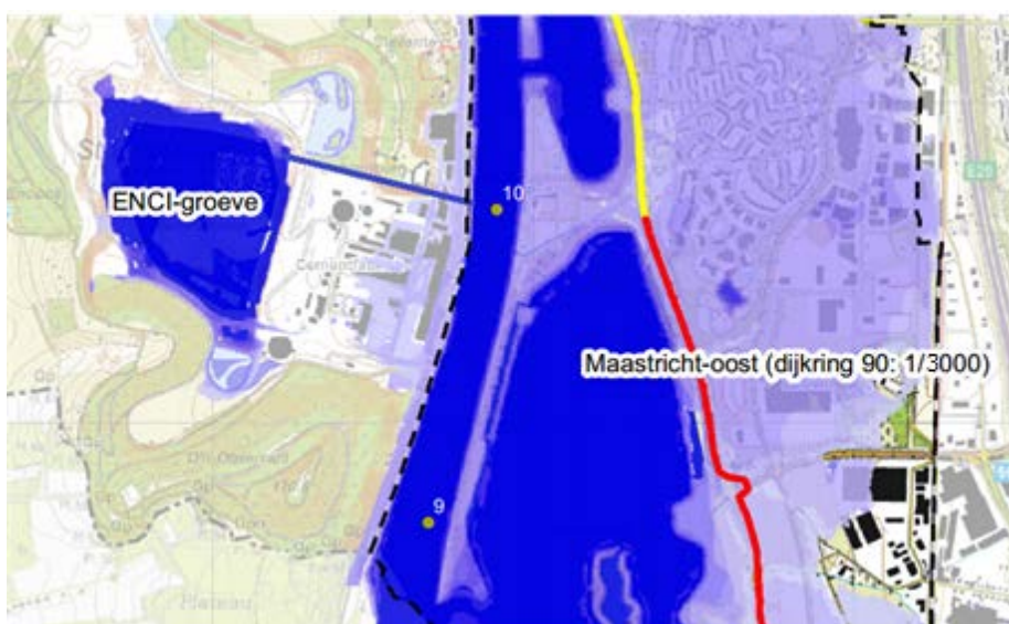
Figuur 1. De groeve met ca. 7,5 mln. m 3 retentiecapaciteit kan via een kanaal vanuit de Maas gevuld worden door een inlaatwerk te openen (of een wand te laten kantelen). Indien het vullen van de groeve symmetrisch rondom de piek van het hoogwater plaatsvindt kan een piekvervlakking van ca. 100 m 3 /s gerealiseerd worden, die ver in benedenstroomse richting doorwerkt.
